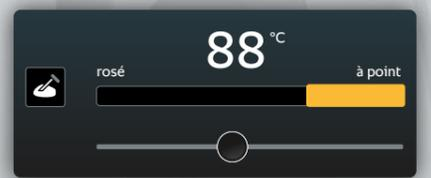
La sonde de température à cœur intégrée, dotée de six points de mesure, détecte la taille de l'aliment à cuire et sa quantité. Elle permet d'atteindre précisément la température à cœur sélectionnée et garantit le résultat attendu. Et le résultat de la préparation sera le même la fois suivante.
